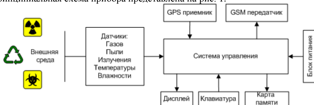
Рис. 1. Структурная схема прибора для мониторинга окружающей среды
