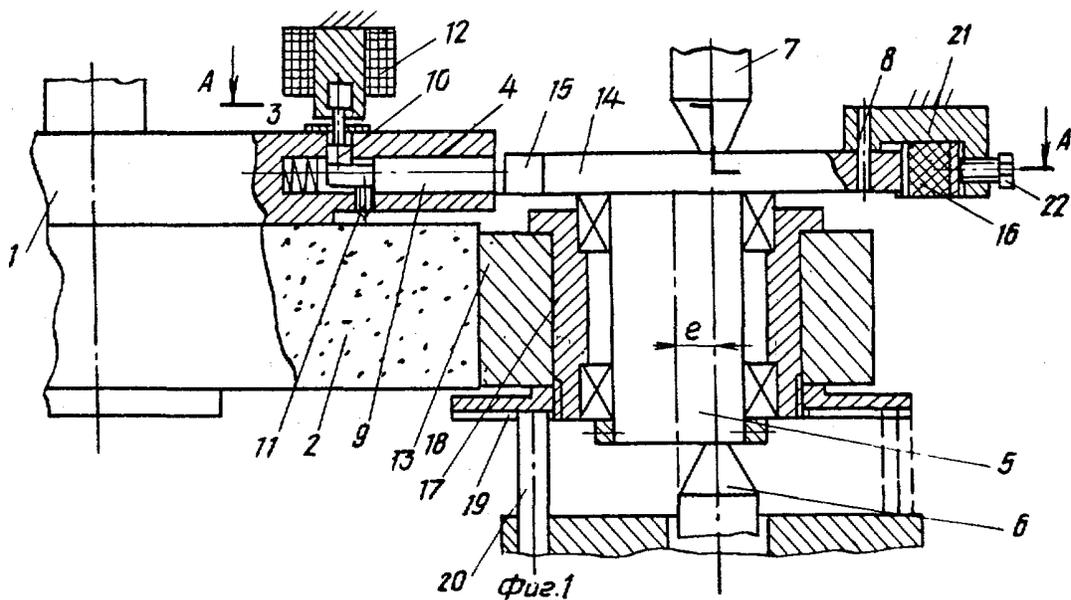
Изобретение относится к машиностроению, в частности к шлифованию и может быть использовано для получения корня стружки при шлифовании.
