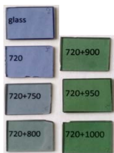
Рисунок 1 – Изображения исходного стекла и прозрачной стеклокерамики, с указанием режима термообработки, (температура, °С/время, ч)
