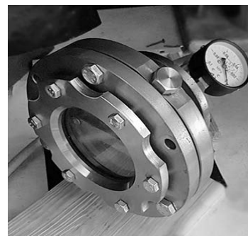
Рисунок 1 – Схема (а) и фотография (б) экспериментальной установки для вакуумной интенсификации процесса заполнения дефектов пенетрантами
