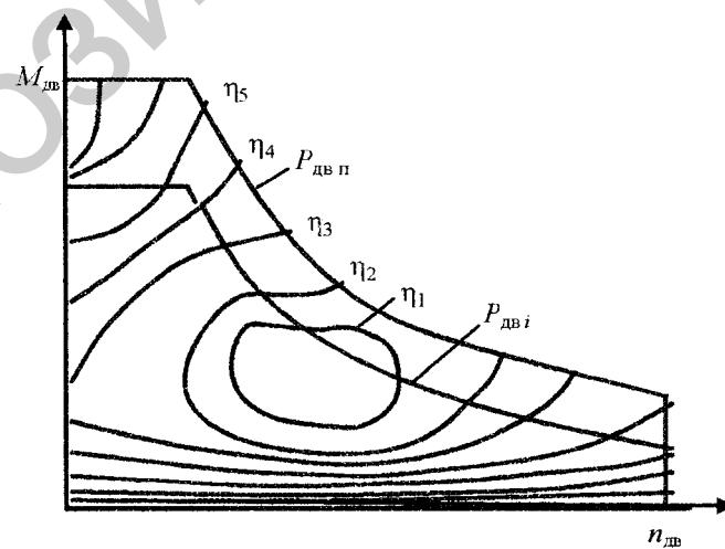
Рис. 3. Тяговые характеристики электродвигателя при постоянных значениях  $P_{\text{дв п}}$ ,  $P_{\text{дв i}}$  мощности и постоянных значениях  $\eta_i$  ( $\eta_i > \eta_{i+1}$ ) коэффициента полезного действия
