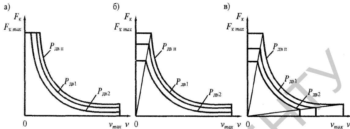
Рис. 2. Семейство тяговых характеристик подвижного состава:  $P_{\text{дв}2}$ ,  $P_{\text{дв}1}$ ,  $P_{\text{дв}2}$  – значения мощности двигателя, соответствующие предельной и частичным характеристикам
