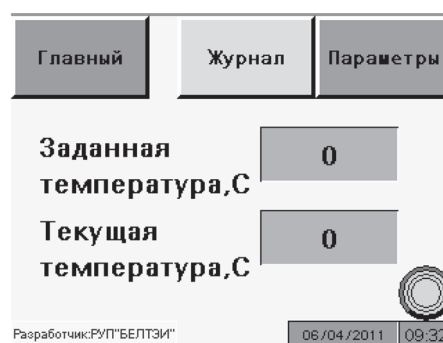
Рис. 9. Главный экран панели оператора
