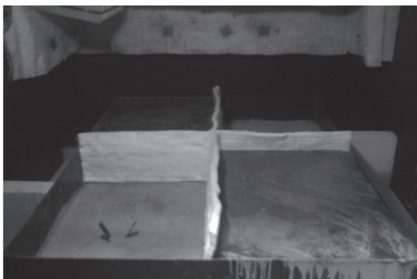
Рис. 7. Установка компенсирующей прокладки
