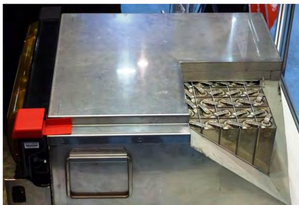
Рисунок 2– Аккумуляторная батарея
