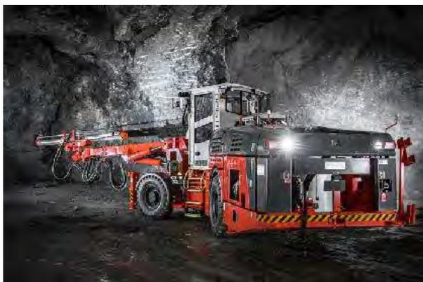
Рисунок 1 – Буровая установка
