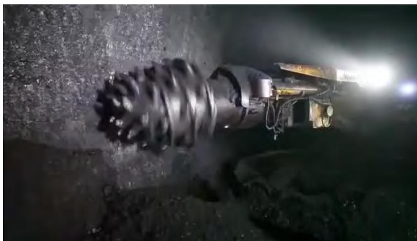
Рисунок 3 – Бур с электродвигателем
