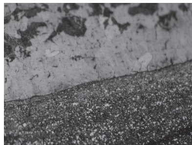
Рис. 7. Микроструктура наружной части (сталь Р6М5) и переходного слоя поперечного разреза биметаллической заготовки метчика. \times 100
