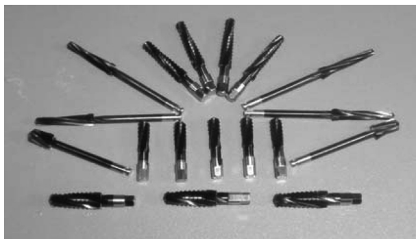
Рис. 1. Сверла с коррозионно-стойким и износостойким покрытием
