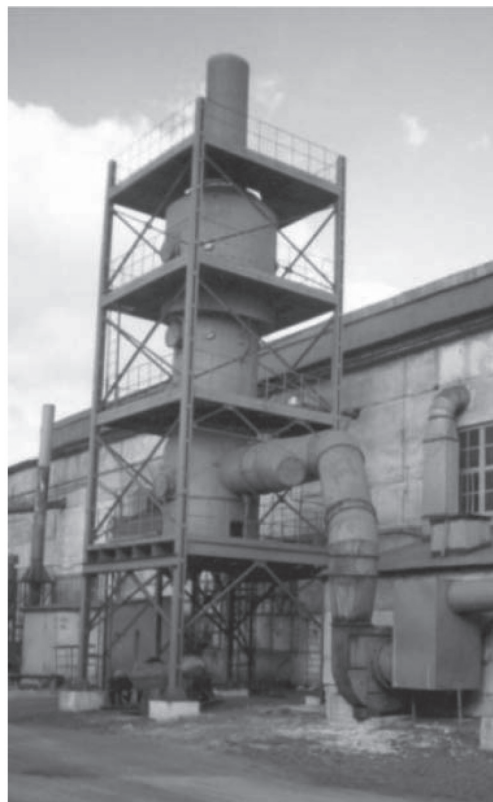
Рис. 3. Абсорбер производительностью по вентиляционному воздуху 40 тыс. м 3 /ч на ООО «Лебединский машиностроительный завод»
