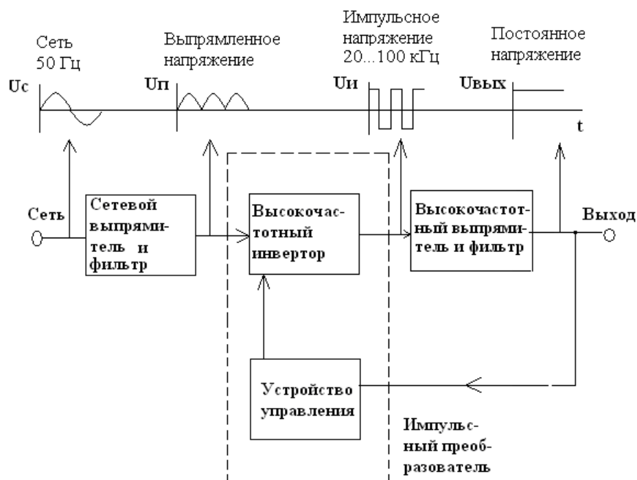
Рисунок 2.37 - Структурная схема импульсного источника питания
