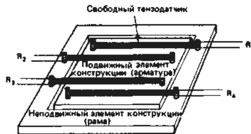
Рис. 9.5. Четыре свободных тензодатчика, образующие мостовой телеметрический преобразователь
