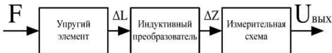
Рисунок 3.4 – Структурная схема индуктивного датчика усилий
