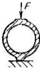
Рисунок 15.3 – Конструкция кольцевого упругого элемента
