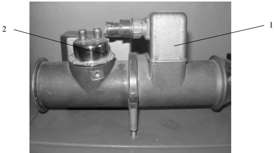
Рисунок 6 – Измерительный модуль расходомера
