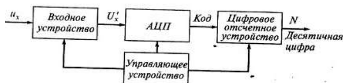
Рисунок 9 – Упрощенная структурная схема цифрового вольтметра.
