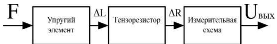
Рисунок 3.3 – Структурная схема тензорезисторного датчика усилий
