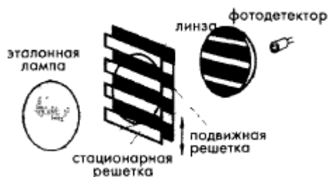
Рисунок 9.27 – Конструкция решетчатого оптического преобразователя
