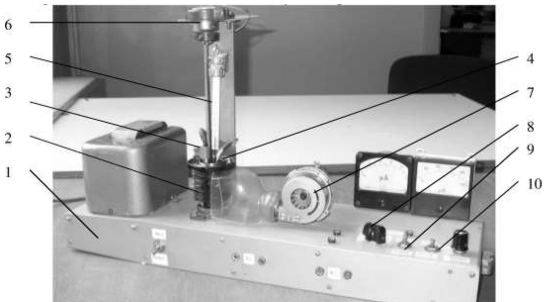
Рисунок 5 – Установка лабораторная, для исследования ВАХ терморезисторов 1 – основание; 2 – камера; 3 – электронагреватель; 4 – терморезисторы; 5 – термометр; 6 – мешалка; 7 крыльчатка; тумблер «Режим»; 9 – тумблер «Нагрев»; 10 – тумблер «Охлаждение».
