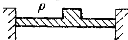
Рисунок 15.7 – Конструкция мембраны с несимметричным центром
