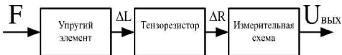
Рисунок 1 – Структурная схема тензорезисторного датчика
