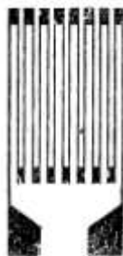
Рисунок 15.14 – Конструкция фольгового тензорезистора
