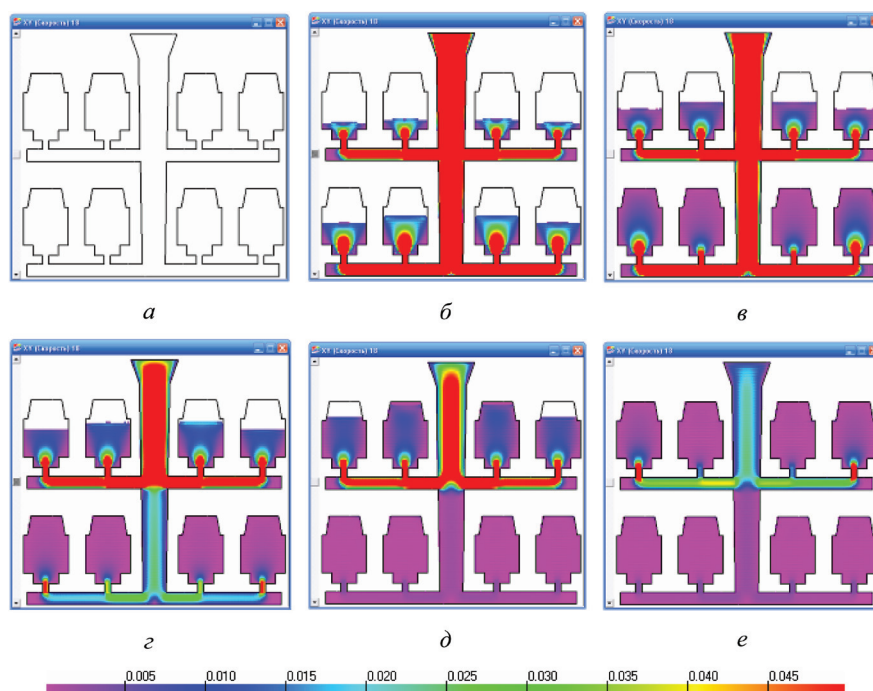
Рис. 5. Распределение скоростей в центральном сечении отливки в двухъярусной литниковой системе для различных моментов времени: a – 0; б – 4 с; в – 8; г – 10; д – 14; е – 18 с
