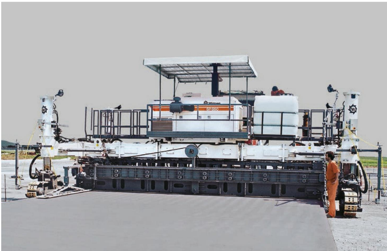
Рисунок 1 – бетоноукладчик со скользящими формами.
