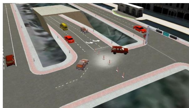
Рисунок 4 – Концепция портала тоннеля в точке В
