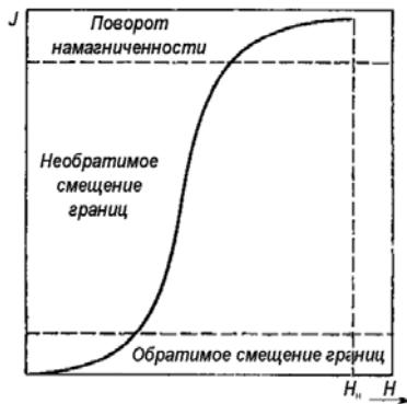
Рис. 3. Типичная зависимость намагниченности J ферромагнетика от напряжённости внешнего магнитного поля H
