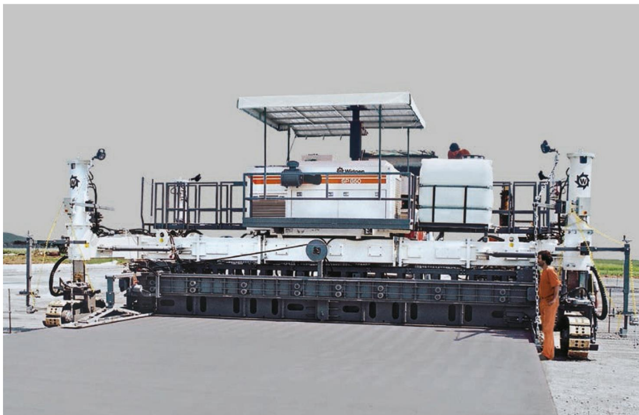
Рисунок 1 – бетоноукладчик со скользящими формами.
