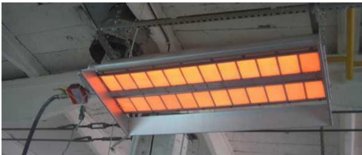
Рисунок 7 – Инфракрасная установка для прогрева бетона в зимнее время
