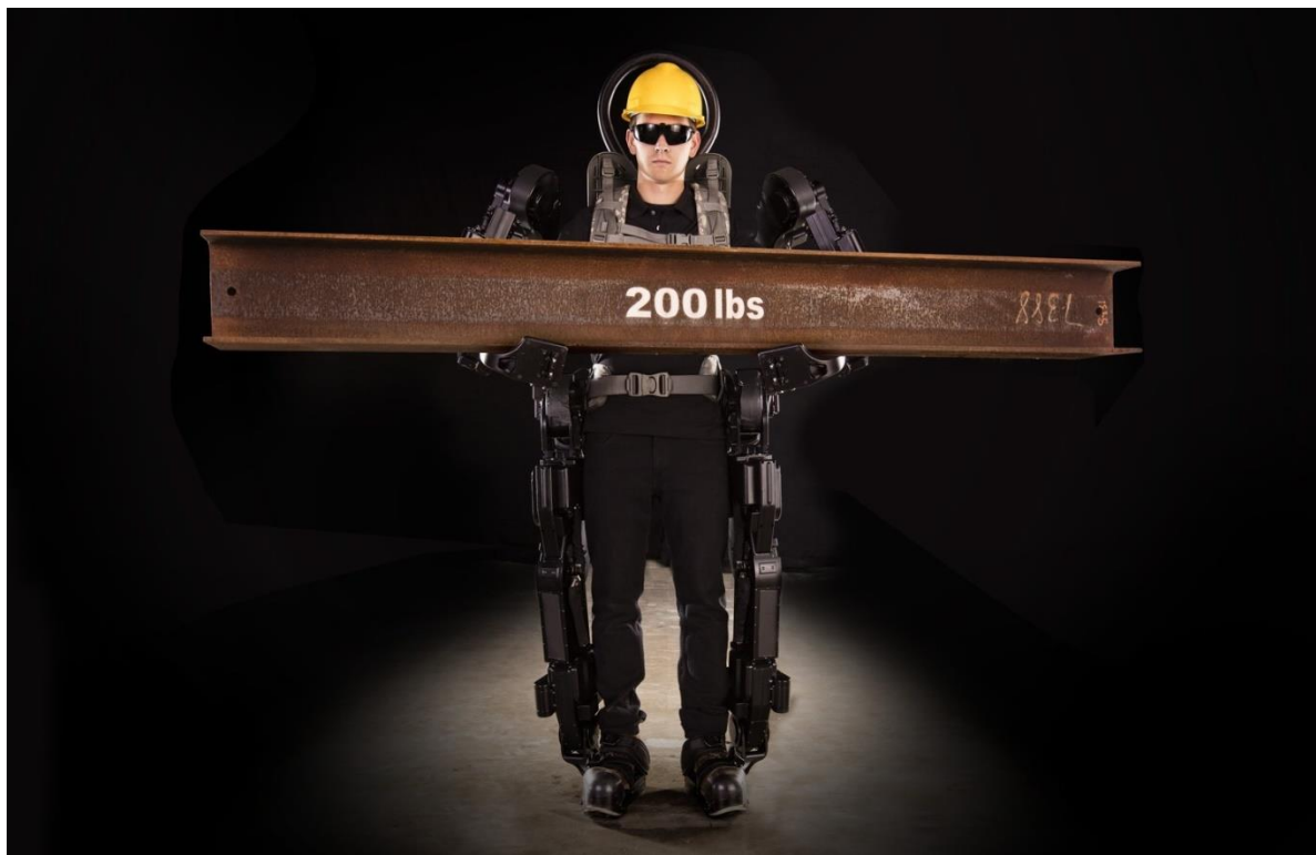
Рисунок 4 – Строительный экзоскелет Guardian XO Max
