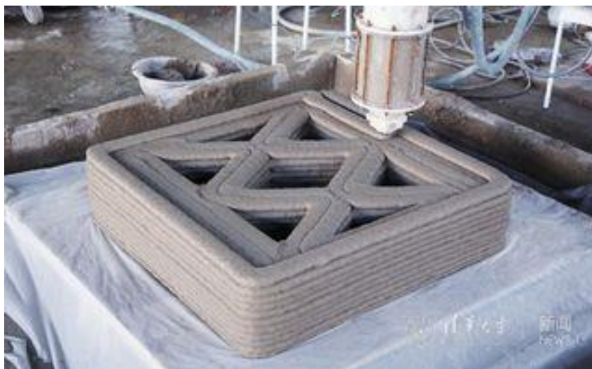
Рисунок 2 – Начальная стадия печати 3д моста в Шанхае
