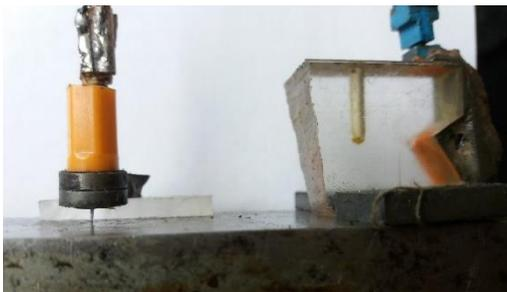
В ходе разработки, для проверки работоспособности устройства, осуществлено макетирование устройства контроля скорости звука с малошумящими точечными преобразователями. На рисунке наглядно изображён датчик во время проведения эксперимента.
