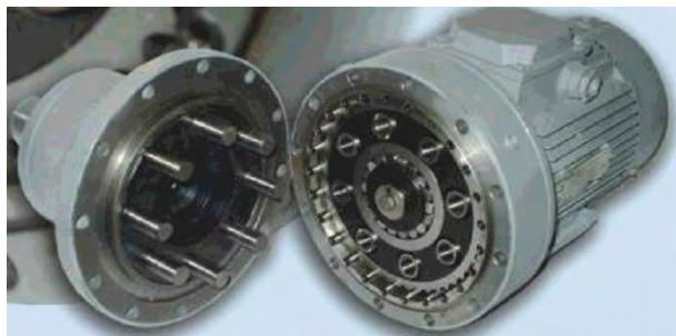
Рис. 2. Планетарный цевочный редуктор МПЦЦ 82-G25
