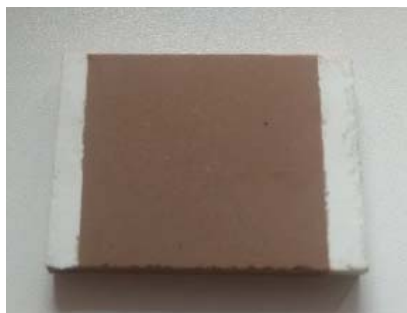
Рисунок 3 – Нанесенный слой алмазоподобного покрытия на керамический образец
