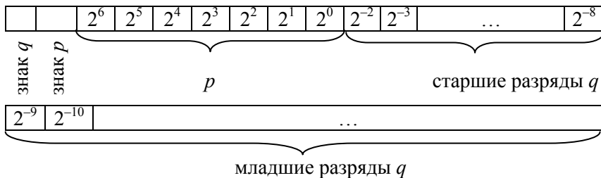
Рис. 2.1. Размещение вещественного числа в разрядной сетке
