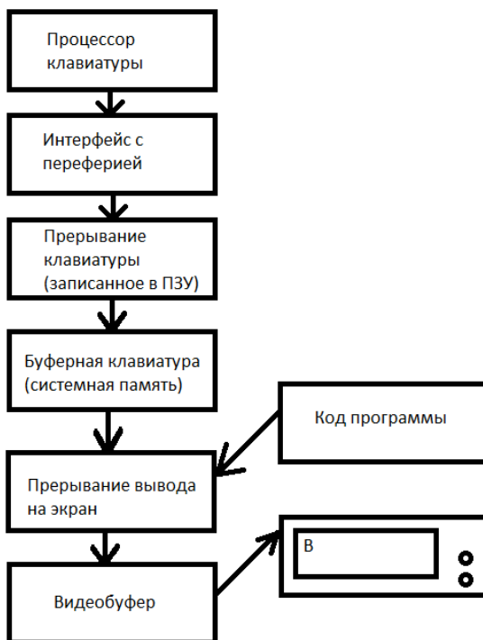
Рис. 6.1. Процесс отображения символа на экране монитора после нажатия соответствующей клавиши клавиатуры
