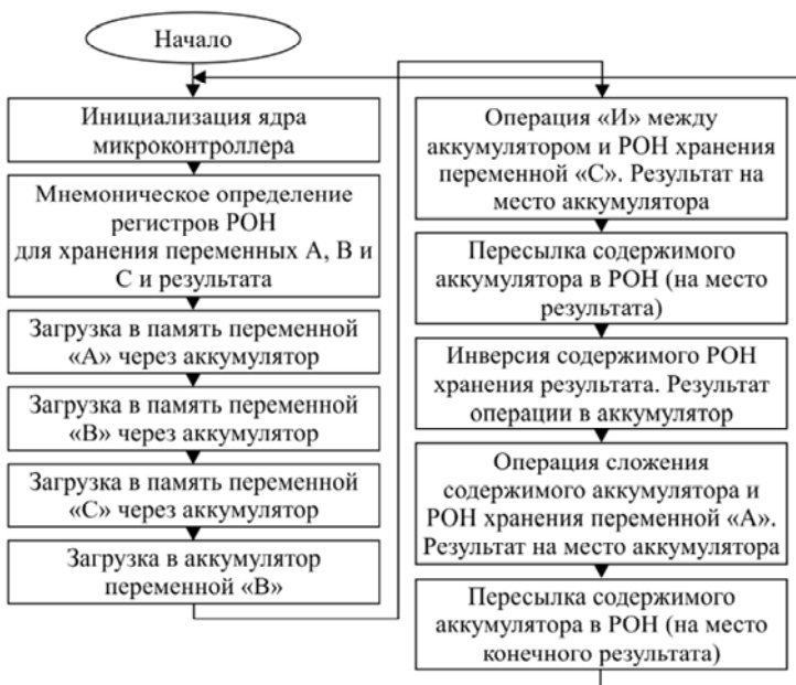
Рис. 1.5. Алгоритм программы нахождения значения функции
