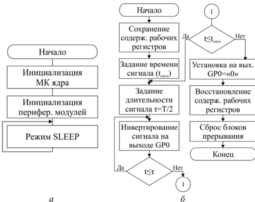
Рис. 2.2. Алгоритм работы устройства: а) основная программа; б) обработка прерывания
