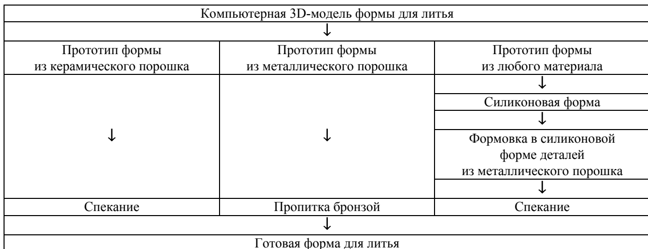
Рис. 4. Схемы использования технологий быстрого прототипирования при изготовлении форм для литья деталей из металла
