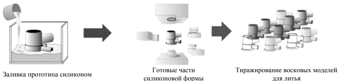
Рис. 3. Схема подготовки партии восковых моделей с использованием силиконовых форм
