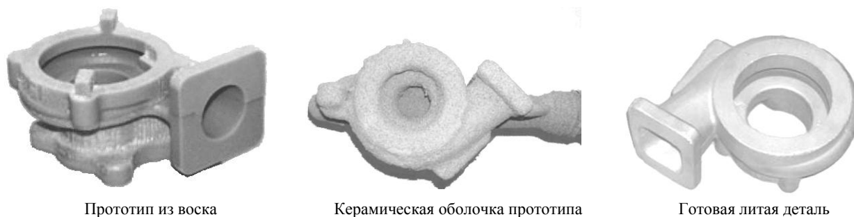
Рис. 2. Основные этапы литья по выплавляемой модели-прототипу
