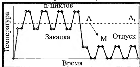
Рисунок 2- Диаграмма УТЦО быстрорежущей стали, включающая термоциклирование выше и ниже критической точки A_1 с закалочным охлаждением на последнем цикле и отпуском
