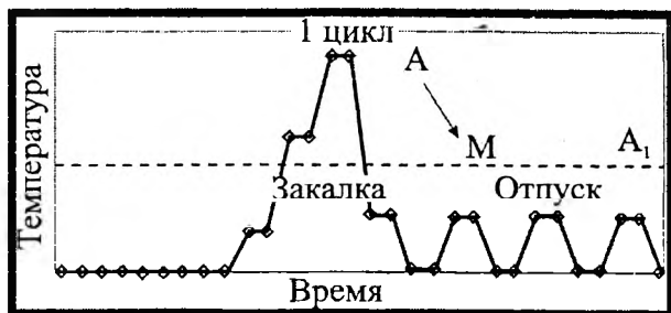
Рисунок 1- Диаграмма традиционной термической обработки быстрорежущей стали
