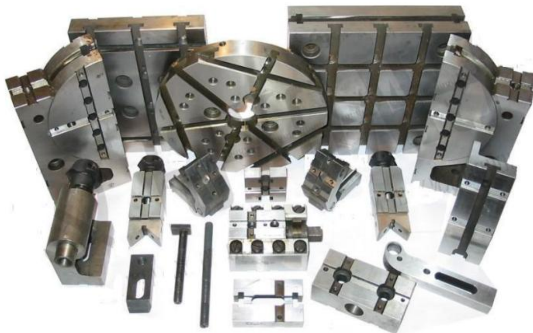
Рисунок 4 - Набор деталей и сборочных единиц УСП
