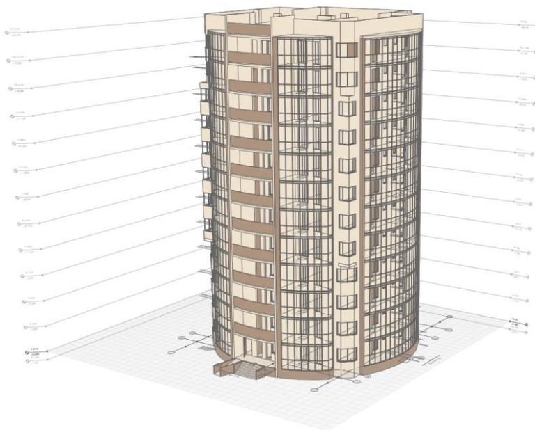
Рисунок 1– BIM-модель здания разделением элементов по пространственным осям в BIM-системе Renga Architecture
