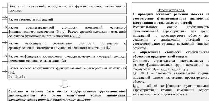
Рисунок 3 – Порядок применения стоимостных показателей строительства помещений различного функционального назначения в разработке архитектурно-планировочных решений
