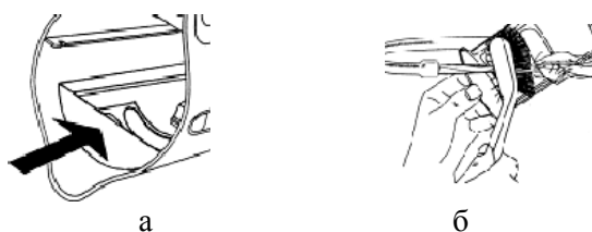
Рис. 5.6. Установка (а) и очистка (б) фильтра
