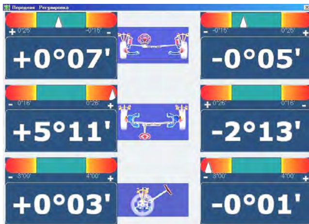
Рис. 4.17. Схема одновременного измерения углов развала, схождения и наклона оси поворота переднего моста автомобиля
