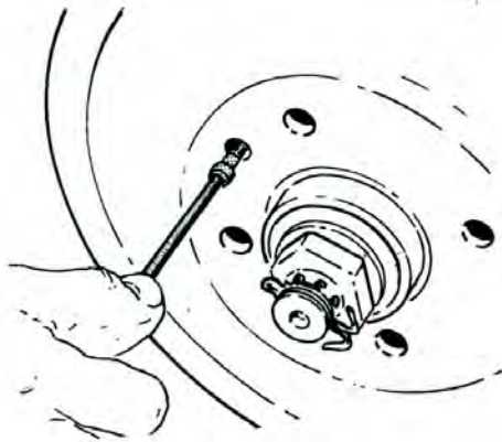
Рис. 2.43. Отворачивание крепежного болта тормозного барабана
