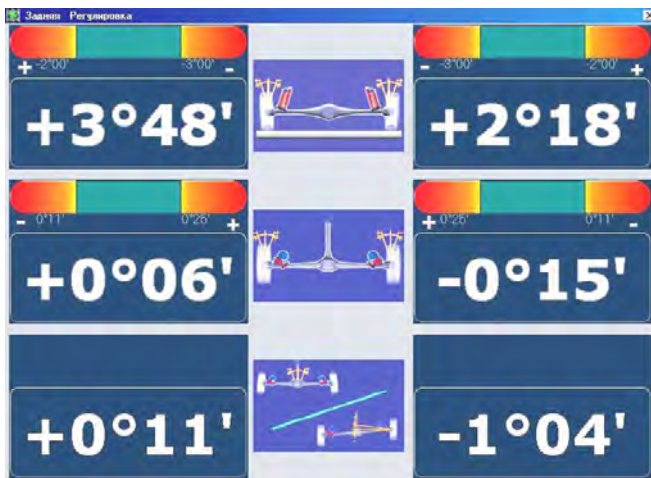
Рис. 4.18. Схема одновременного измерения углов развала, схождения и наклона оси поворота заднего моста автомобиля
