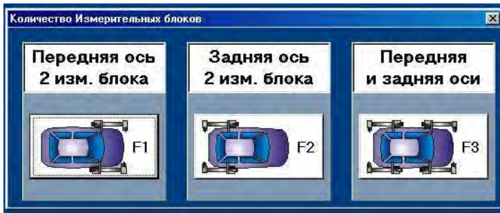
Рис. 4.14. Схемы измерения параметров углов установки колес: Схема F1 – измерение параметров передней оси двумя передними ИБ; схема F2 – измерение параметров задней оси двумя передними ИБ; схема F3 – измерение параметров передней и задней осей четырьмя ИБ
