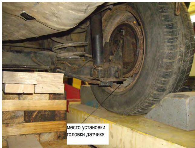
Рис. 5.2. Установка датчика при статической балансировке колес
