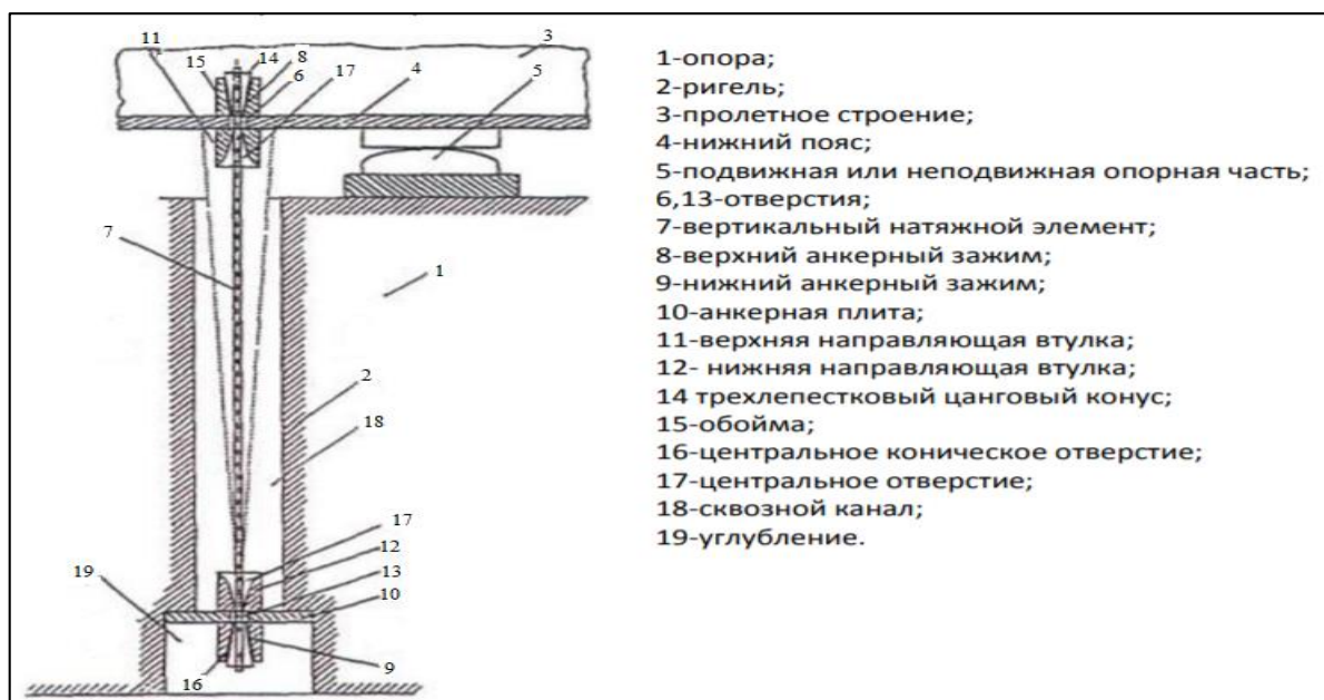
Рисунок 2 – Строение анкера
