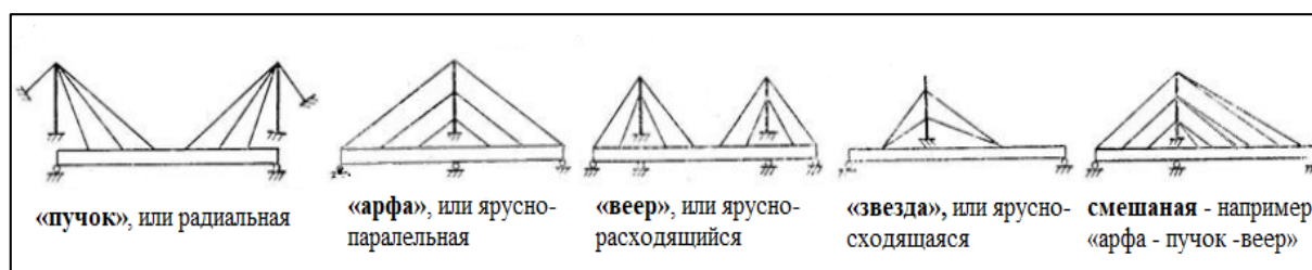
Рисунок 1 – Системы вантовых мостов
