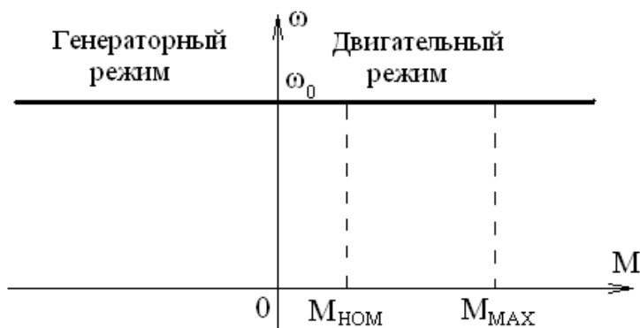
Рисунок 3.26 – Механическая характеристика синхронного двигателя
