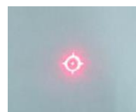
Рисунок 1 – Фотография голограммы прицельной марки
