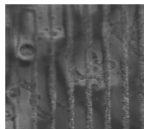
Рисунок 1 – Пленка с клетками культуры дрожжей на поверхности электродов биоанализатора
