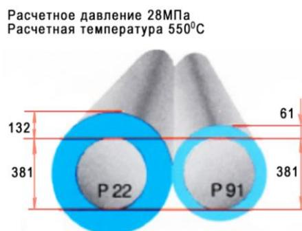
Рисунок 1 – Сравнение толщин стенок труб из теплоустойчивой P22 (ближайший аналог 12Х2М) и жаропрочной стали P91 (ближайший аналог 10Х9МФБ).
