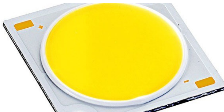
Рисунок 2 – Внешний вид матрицы на светодиодах COB
