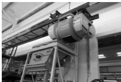
Рис. 21. Пост приема бетонной смеси из кубеля адресной подачи
