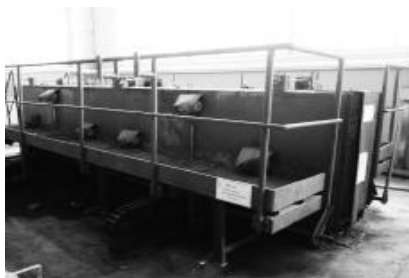
Рис. 20. Кассетная установка для производства лестничных маршей
