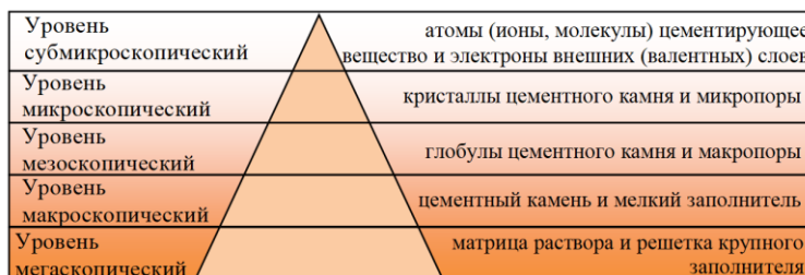
Рис. 4. Уровни сложности структуры бетона
