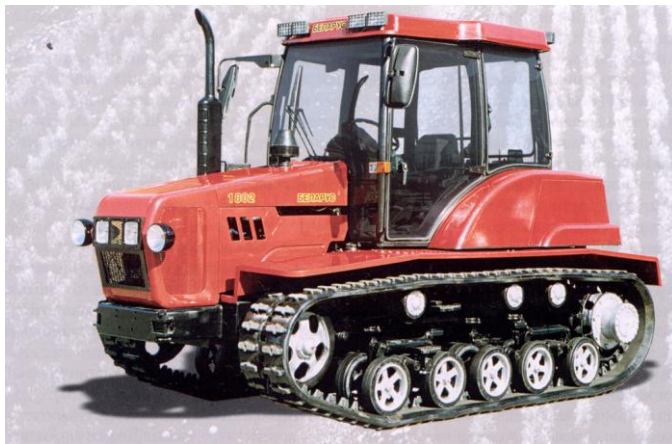
Рисунок 10 – Современный гусеничный трактор «Беларус-1802» мощностью 180 л. с.
