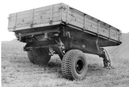
Рисунок 7 – Полуприцеп с изменяемой геометрией ходовой системы (испытания на Киргизской МИС, г. Кант)
