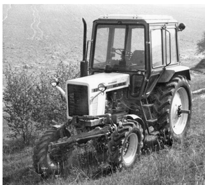
Рисунок 5 – Трактор «Беларус» с изменяемой геометрией ходовой системы (испытания на полигоне МТЗ, д. Абчак, Минский р-н)
