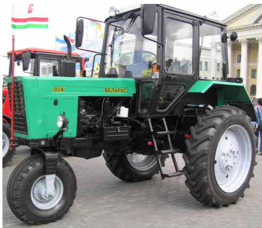
Рисунки 15 – Трактор «Беларус» МТЗ-80Х хлопковой модификации с унифицированной кабиной на выставке
