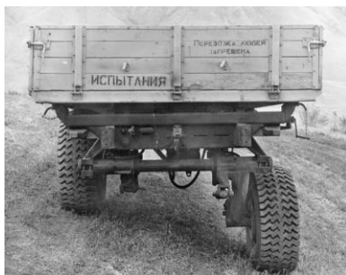
Рисунок 7 – Полуприцеп с изменяемой геометрией ходовой системы (испытания на Киргизской МИС, г. Кант)
