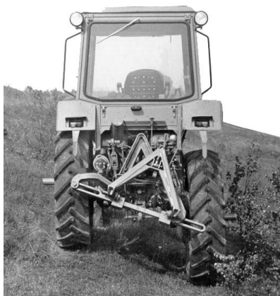
Рисунок 6 – Механизм коррекции положения навешиваемых на трактор с изменяемой геометрией ходовой системы машин и орудий
