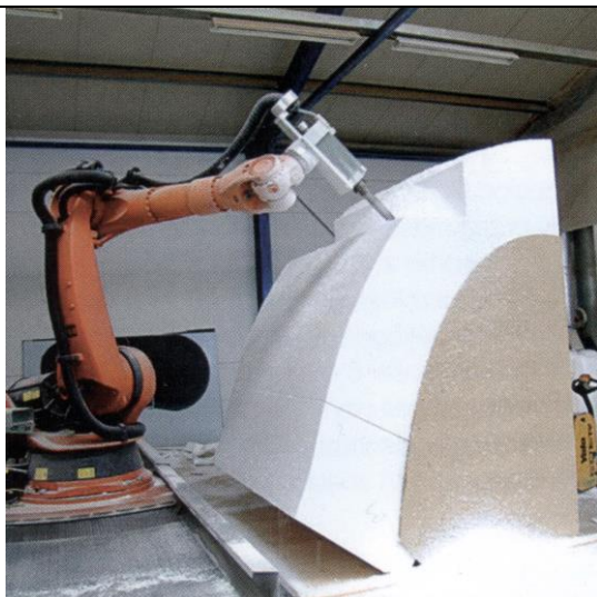
Рис. 3.5. Изготовление опалубки для строительных конструкций сложной формы с помощью промышленных роботов
