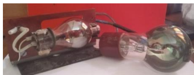
Рис.1. Конструкция и общий вид исследуемых образцов вакуумных фотоэлементов
