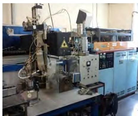
Рис. 2. Установка для селективного лазерного спекания
