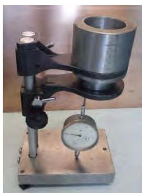
Рис. 1. Приспособление для подачи порошка
