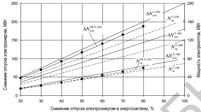
*Рис. 2. Зависимость снижения отпуска электроэнергии (сплошные линии) и требуемая мощность электрокотлов (штриховые линии) от относительного снижения отпуска электроэнергии в энергосистему от установок различного типа*
