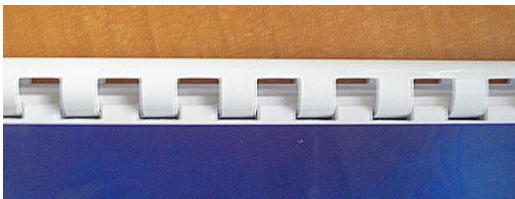
Рисунок 2 - Брошюровка на пластиковую пружину
