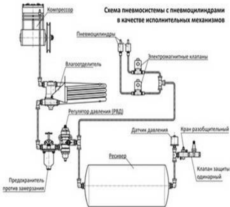
Рисунок 51 – Пневмосистема с пневмоцилиндрами
