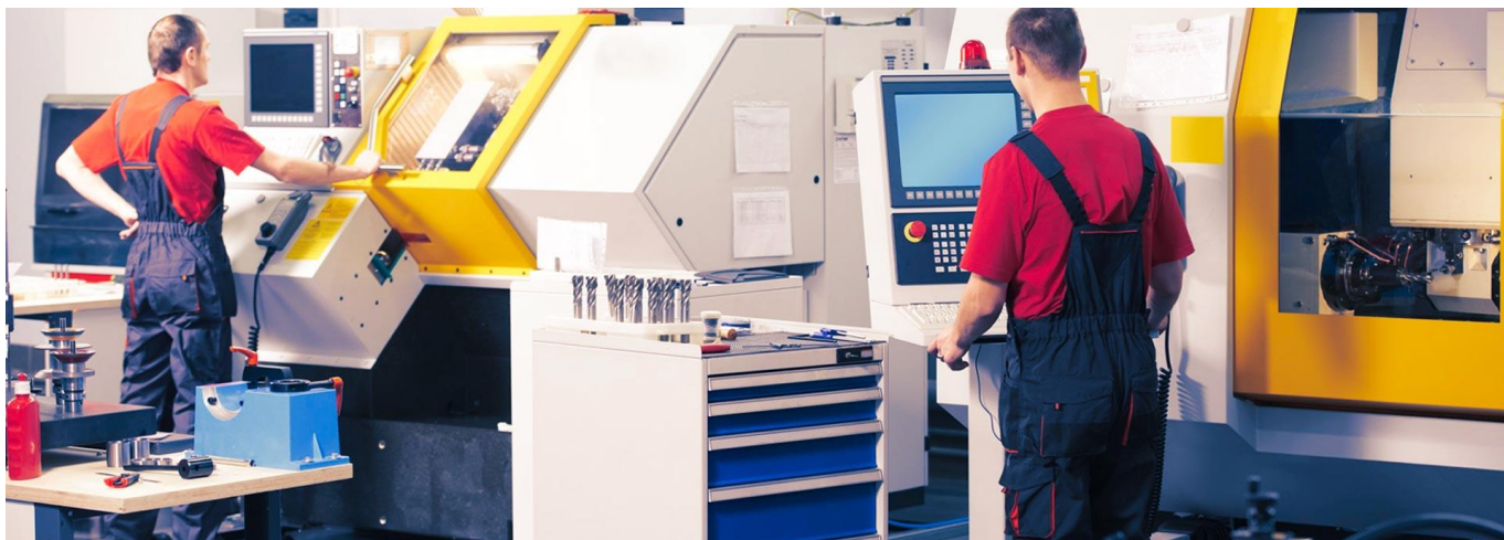
Рисунок 70 – Наладка станка с ЧПУ
