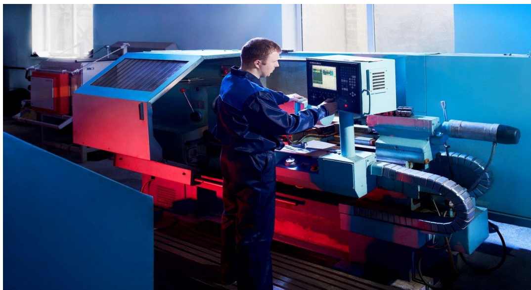
Рисунок 71 – Наладка станка с ЧПУ
