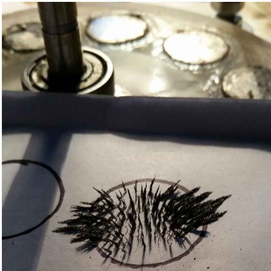
Рисунок 1. Картина силовых линий магнитного поля одного магнита ротора, полученная из железных опилок. (Контуром обведено положение соседних магнитов на роторе).
