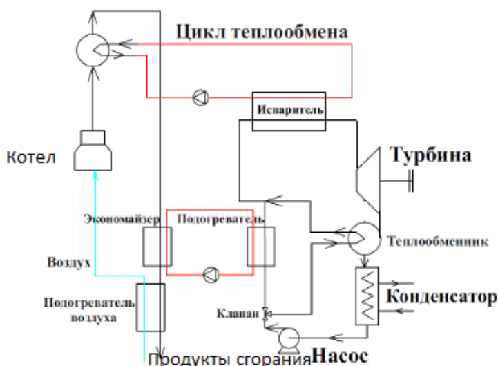
Рисунок 1. Схема теплофикационной установки, работающей по ОРЦ.
