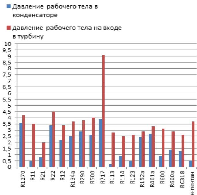
Рисунок 3. Давления рабочего тела в характерных точках цикла
