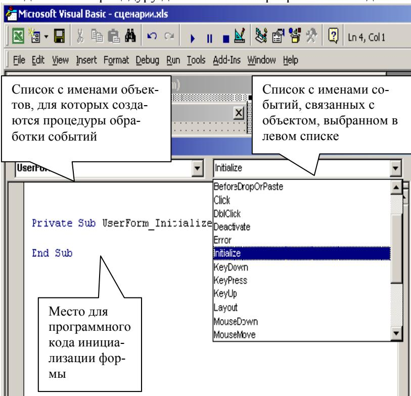
Рис. 15. Модуль программного кода инициализации формы
