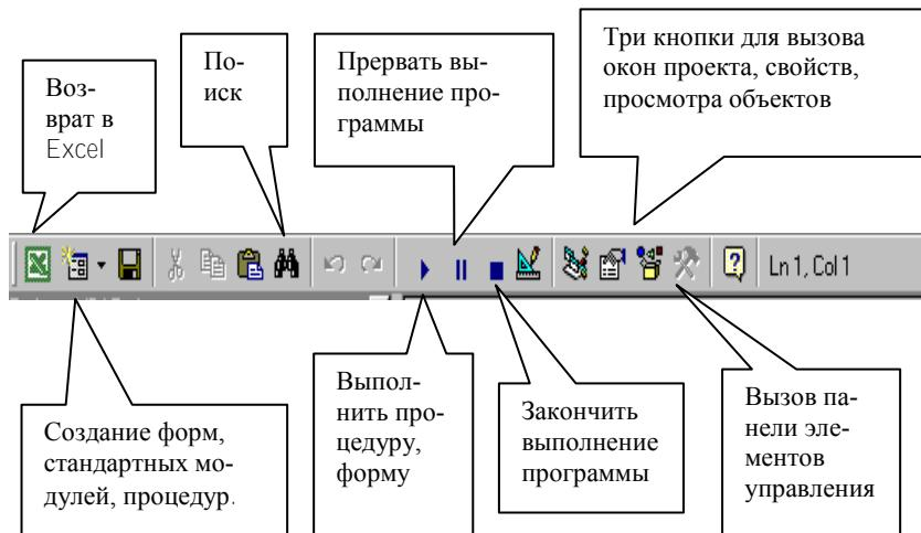
Рис. 3. Панель инструментов редактора VBA.
