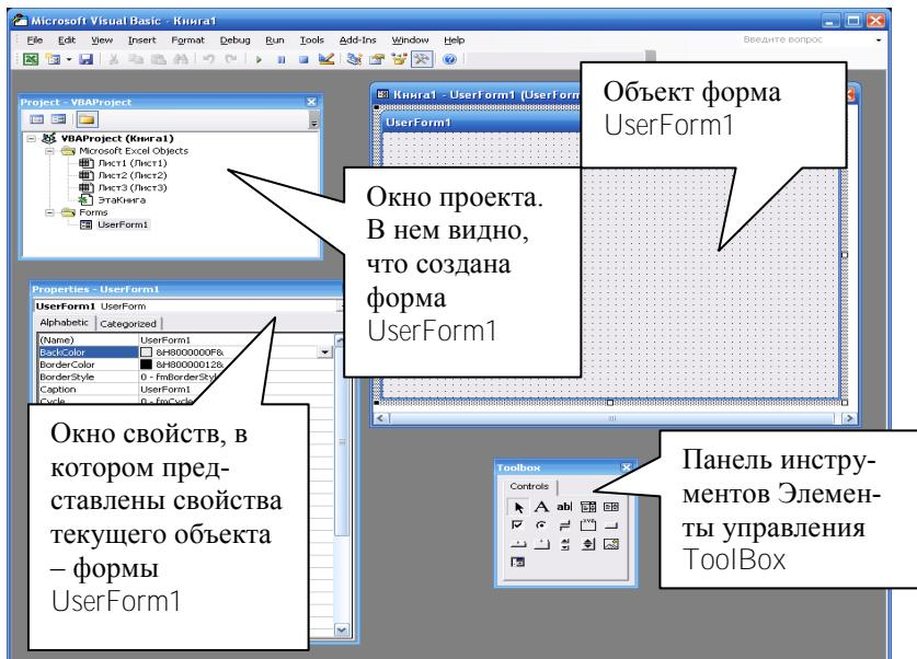
Рис. 14. Вид окна редактора VBE при создании формы
