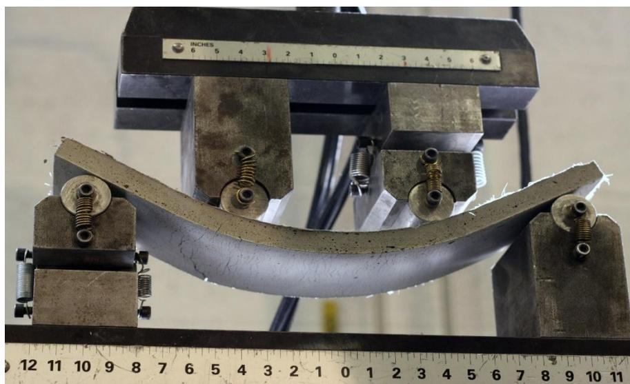
Рисунок 1 – Испытание самовосстанавливающегося бетона на изгиб
