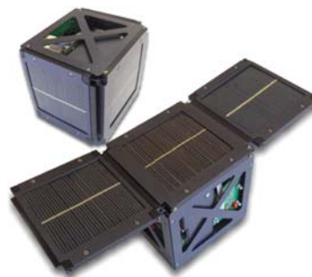
Рисунок 3 – Внешний вид ЭО МСР-08 с закрытыми и раскрытыми панелями солнечных батарей
