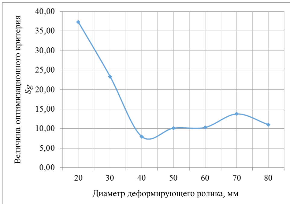
Рис. 6. График зависимости оптимизационного критерия Sg от диаметра ролика для метал-локorda 2 \times 0,30HT
