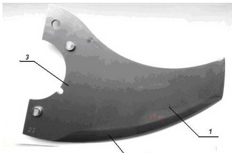
Рис. 5. Нож куттерный для рубки мяса в куттере: 1 – лезвие, 2 – режущая кромка, 3 – посадочная часть ножа
