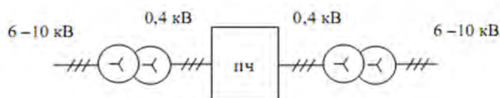
Рис.55.1. Структурная схема высоковольтного ПЧ с двумя трансформаторами
